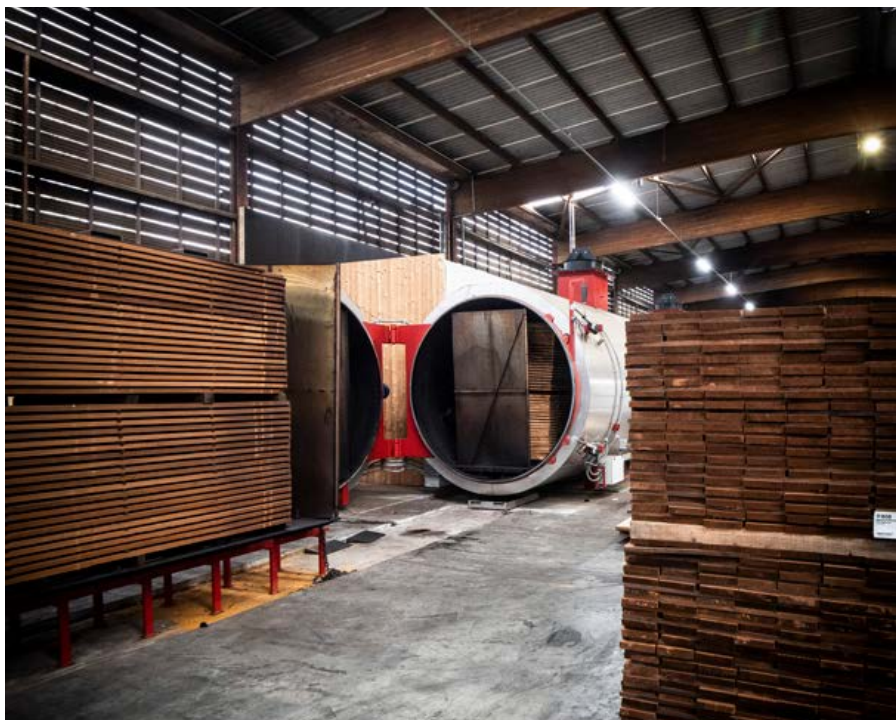
© Cras - Met deze nieuwe installatie verdubbelt Cras zijn productiecapaciteit in thermisch behandeld hout
