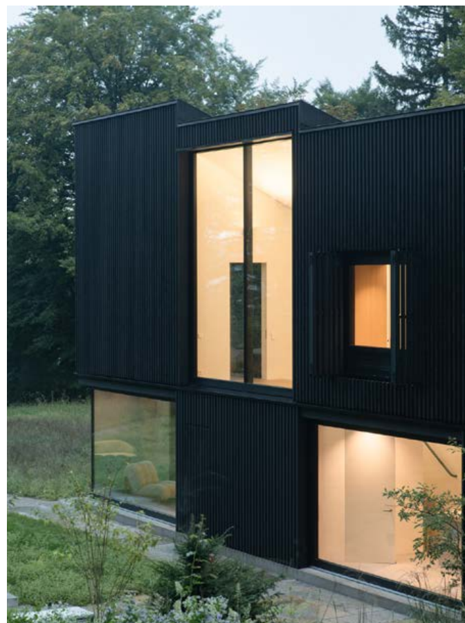
De gevelbekleding loopt door op ingenieuze vouwluiken die licht in de kamers kunnen brengen
