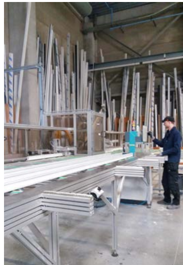
De profielen worden met behulp van zaagoptimalisatie op lengte gezaagd
